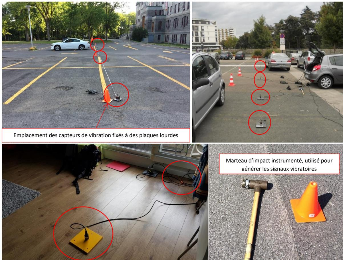
Figure 20 : Illustration des moyens d'essais utilisés lors de la campagne de mesures (juillet 2019)
