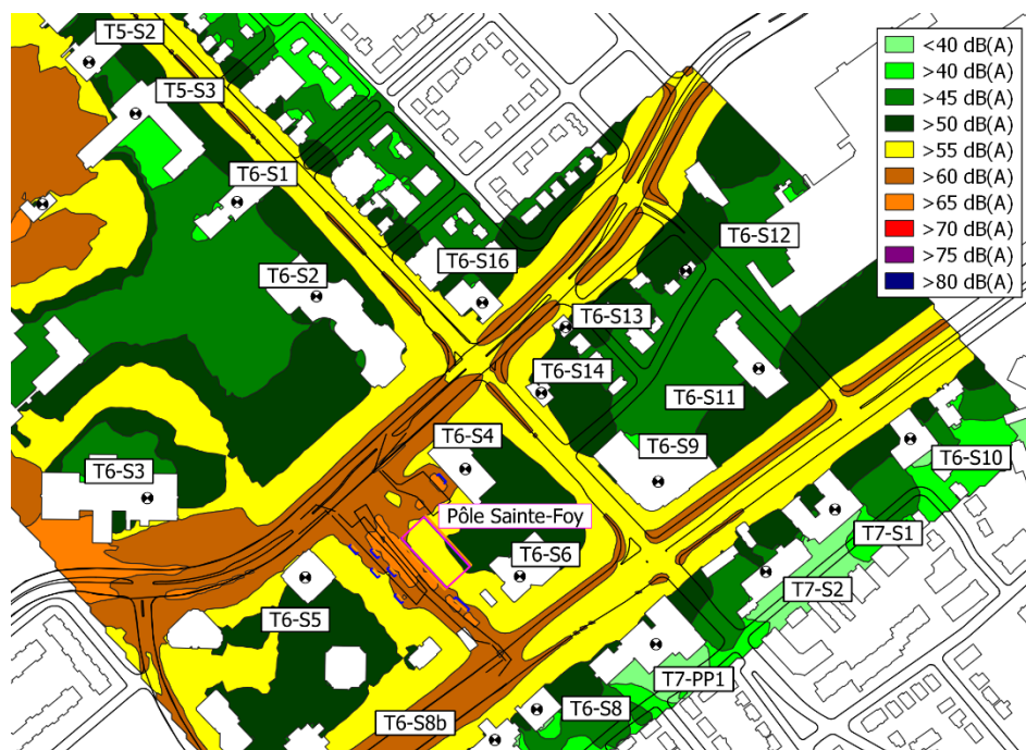
Figure 11 : Cartographie du bruit l'ambiance sonore 2026 – Secteur pôle Sainte-Foy - Niveau de bruit L_n – Hauteur 4m – Échelle 1/4000e
