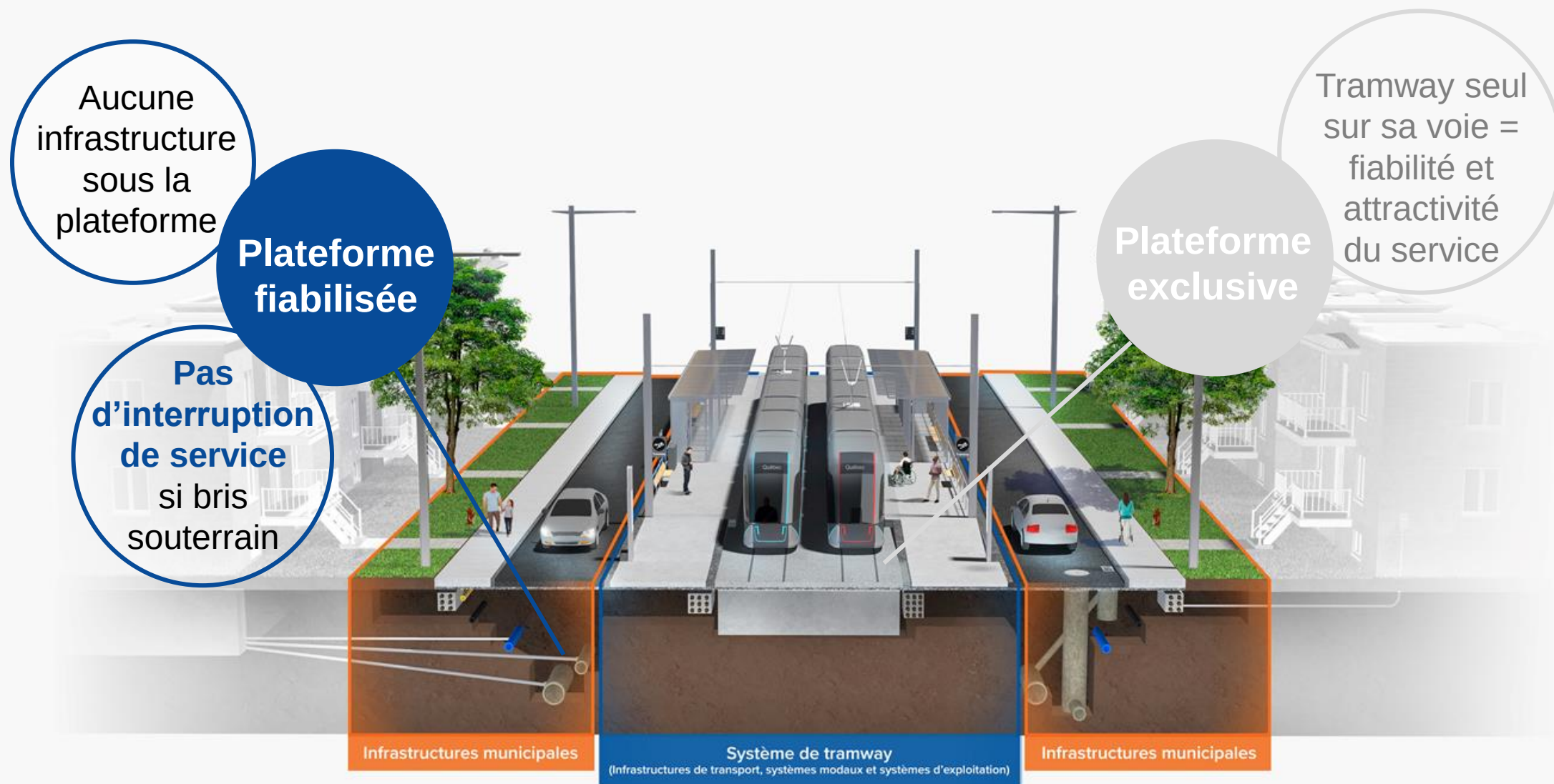
Insertion axiale du tramway en station
