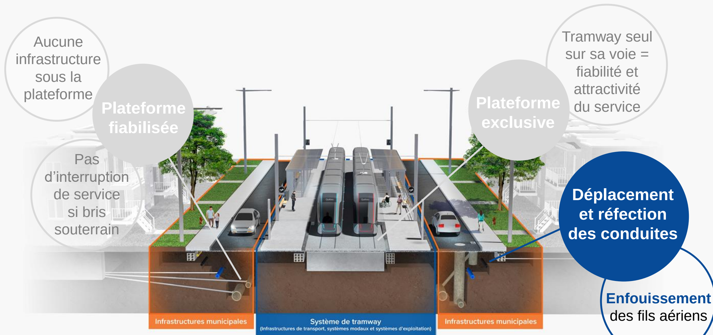
Insertion axiale du tramway en station
