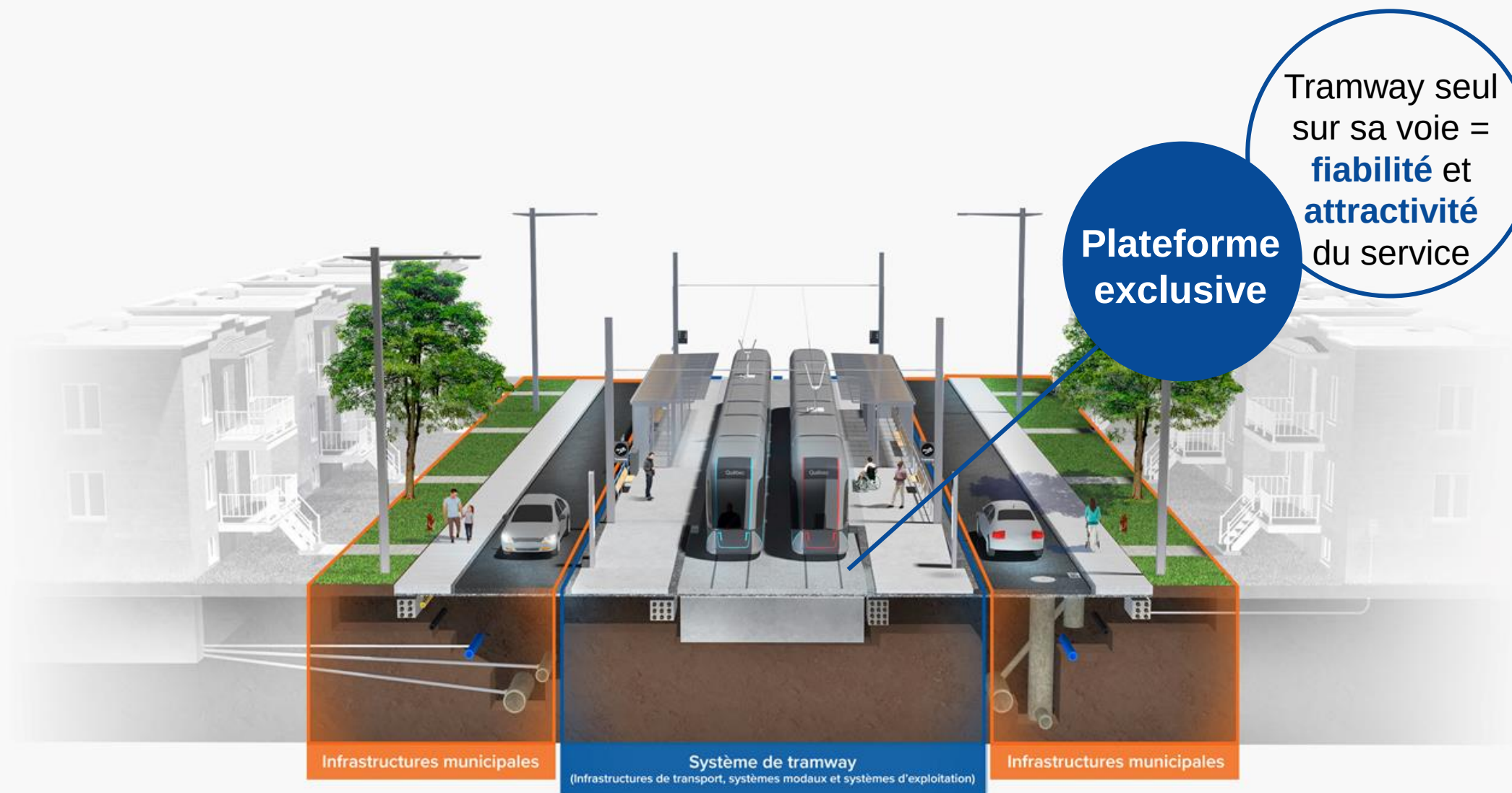
Insertion axiale du tramway en station
